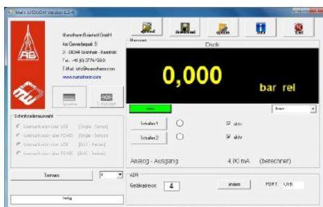
При тарировании актуально измеренная величина заносится в регистр „Offset“ с тем, чтобы в будущем всегда вычитаться (см. раздел „output options“ (Функции давления)). Благодаря этому трансмиттером абсолютного давления также возможно проводить измерения относительного давления и исключать влияние, обусловленное изменением давления воздуха или географической высоты места установки.
