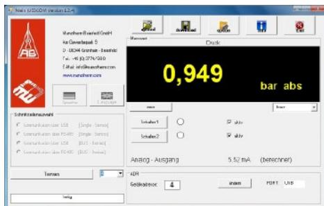
Клавиша „zero“ служит для обнуления трансмиттера, сообщающегося с атмосферой, перед началом измерения относительного давления (дополнение „abs“ на дисплее погашено); показание установлено на „0“, клавиша „zero“ горит зеленым!
